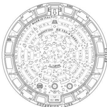
**DESCRIZIONE** Dispositivo di coronamento in ghisa sferoidale GJS 500-7 secondo la norma EN 1563, conforme alla norma EN124-2:2015 in particolare conforme alla classe di portata D400, carico di rottura >400 kN ( $\geq t 40$ ), recante il marchio di certificazione di prodotto IGQ (Istituto Italiano di Garanzia della Qualità) ed il marchio di conformità UNI.
