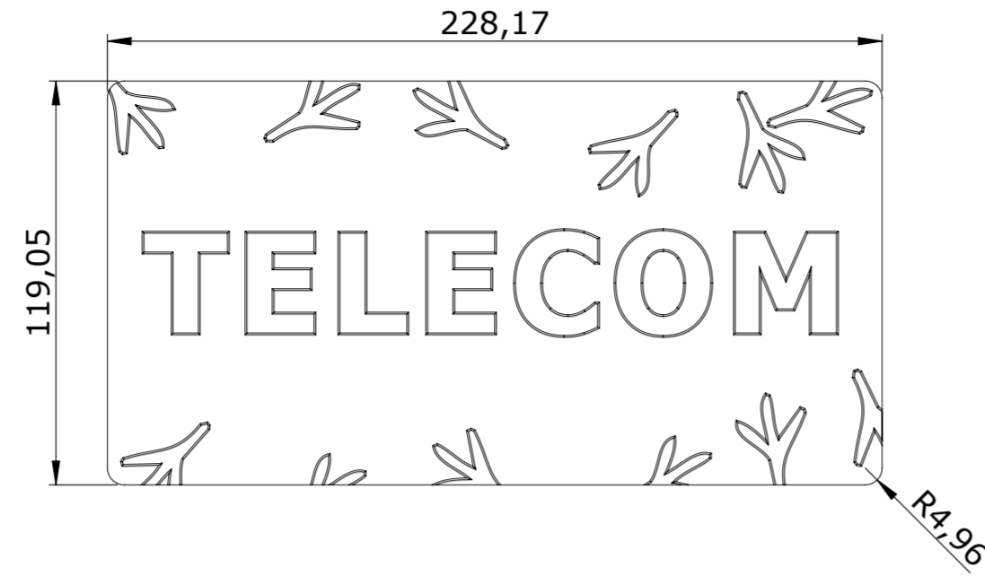
Particolare Marcatura SCALA 1:2
